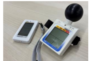
↑この機器で、活動場所の暑さ指数を計測しています。
